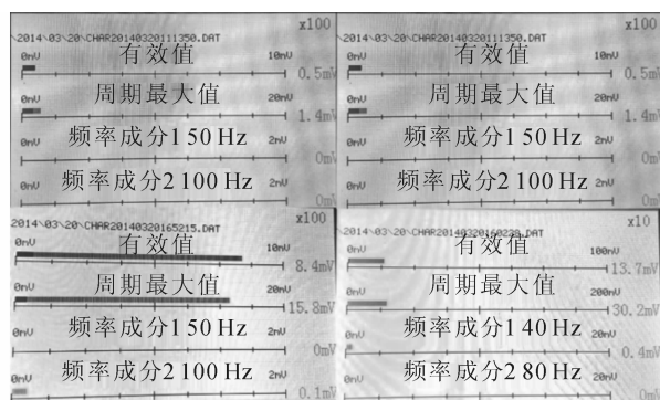
(a) A、B相幅值图与C相幅值图对比 (左图为A、C相对比, 右图为B、C相对比)
