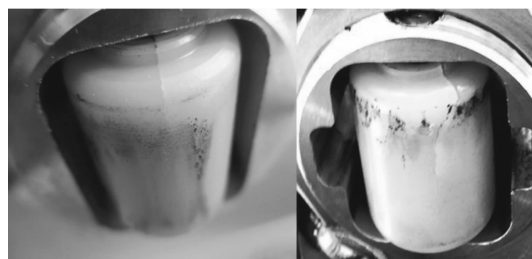
图5 三支柱绝缘子滚轮开裂
