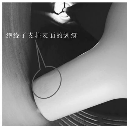
图 9 解体后发现的支柱绝缘子表面划痕
