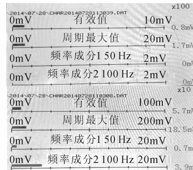
(a)幅值图对比(上图为正常单元幅值图,下图为C相异常单元幅值图)
